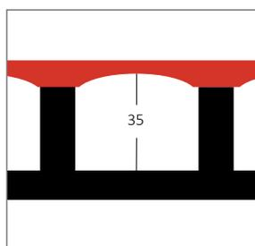
L'ampliamento dell'altezza dei canali, grazie alla speciale smeratura del pannello di chiusura, è ideale per cavi di ampio diametro.
